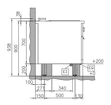
Drain ΕI Electrical inlet (power) EQ Equipotential screw
